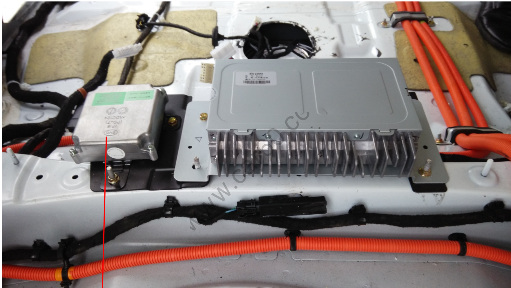
全景影像控制器，与外置功放一起，安装于后行李箱位置
